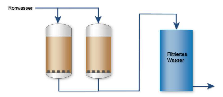
Das Material ist jedoch verhältnismäßig teuer und muss ersetzt werden, wenn es erschöpft ist. Daher sollte es nicht für die Partikelfiltration verwendet werden, da dies die Adsorptionskapazität von GEH reduziert, was zu höheren Kosten führt.
